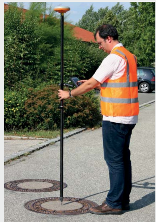
Aufnahme eines Kanaldeckels in der Gemeinde mit Übertragung der Daten ins GIS-System oder per Direktmessung in Esri
