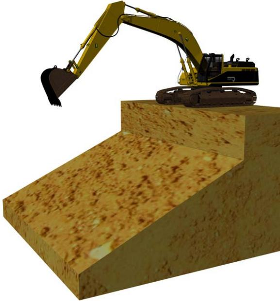
Ein Einfachgefälle ist eine Fläche, die nur in eine bestimmte Richtung abfällt. In DigPilot müssen Sie Folgendes angeben, um ein Einfachgefälle zu graben:
