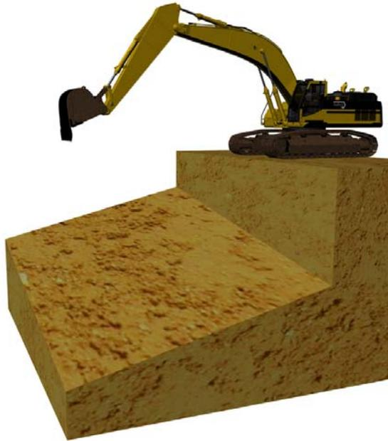
Ein Knickgefälle ist eine Fläche, die in Längsrichtung und seitlich abfällt. In DigPilot müssen Sie Folgendes angeben, um ein Knickgefälle zu graben:
