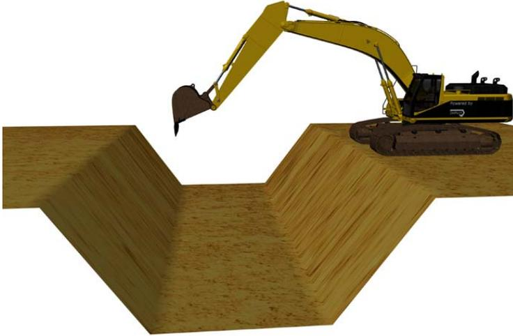
Ein Kanal besteht aus drei horizontalen Flächen mit einem Einfachgefälle dazwischen wie in der vorhergehenden Abbildung dargestellt; er weist das gleiche Gefälle an beiden Seiten des Kanalbodens auf. Für einen Kanal müssen folgende Einstellungen angegeben werden:
