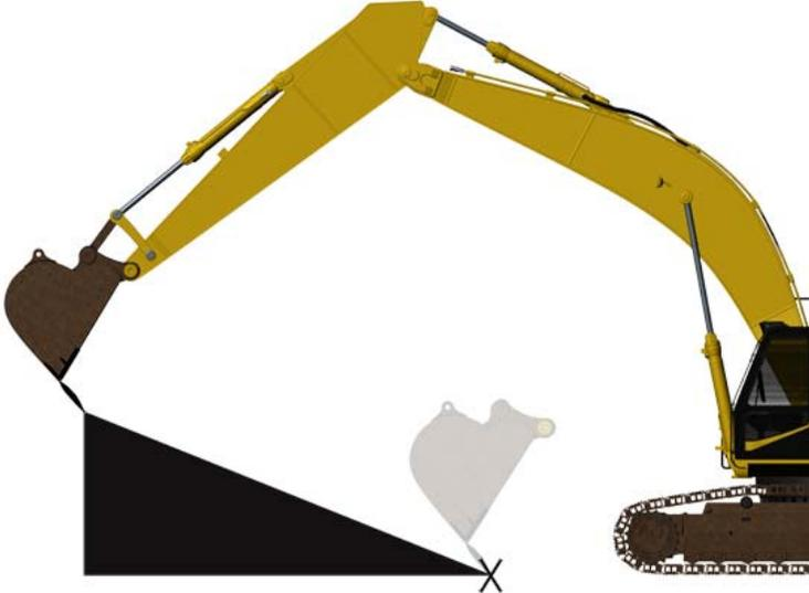
Schaufeldefiniert dient zum Angeben eines Einfachgefälles mit der Schaufelspitze. Dies kann hilfreich sein, wenn Sie beispielsweise ein Einfachgefälle bis zur Grundmauer einer Garage graben müssen.
