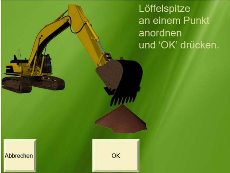
Die Tauschpunktfunktion steht für die Projekte „Ebene“, „Einfachgefälle“ und „Knickgefälle“ zur Verfügung. Vor dem Bewegen der Unterwagen richten Sie die Schaufelspitze an einem Punkt aus, der ebenfalls von der Stelle aus erreicht werden kann, an die Sie die Unterwagen bewegen müssen. Drücken Sie „OK“ am Bildschirm. Bewegen Sie die Unterwagen und ordnen Sie die Schaufelspitze wieder am gleichen Punkt an. Drücken Sie erneut „OK“ am Bildschirm.
