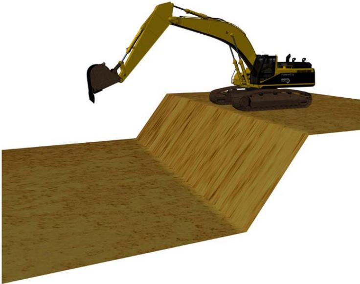
Ein Profil besteht aus zwei horizontalen Flächen in unterschiedlicher Höhe mit einem Einfachgefälle dazwischen. In DigPilot müssen Sie Folgendes angeben, um ein Profil zu graben:
