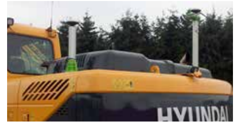
System mit 2 Antennen auf einem Bagger
