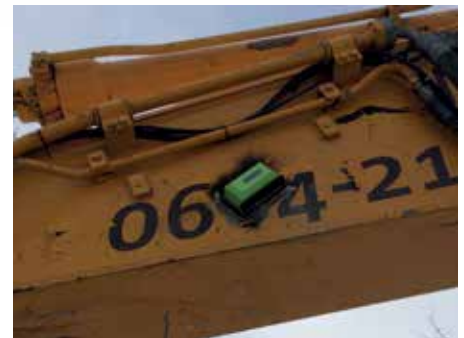
Kabelloser Sensor am Baggerarm
