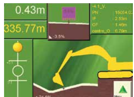
Softwareansicht mit NHN-Höhe (335.77 m) und des verbleibenden Aushubs (0.43 m)
