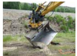
Manche Bagger verfügen über einen Verstellausleger und eine Schwenkschaufel. Auch dafür ist DigPilot geeignet. Mit den entsprechenden Sensoren werden die Bewegungen und die Neigung an den Computer übertragen, grafisch dargestellt und in den Berechnungen berücksichtigt.
