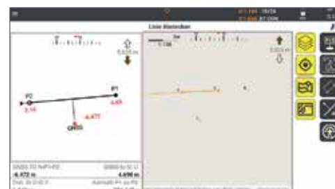
Abstecken einer Linie
