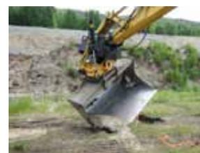
Manche Bagger verfügen über einen Verstellausleger und eine Schwenkschaufel. Auch dafür ist DigPilot geeignet. Mit den entsprechenden Sensoren werden die Bewegungen und die Neigung an den Computer übertragen, grafisch dargestellt und in den Berechnungen berücksichtigt.
